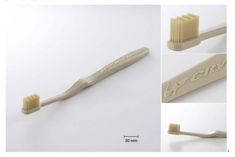
244 根牙刷毛,每根长 12mm,直径 0.3mm。 刷毛非植毛,而是由整块硬塑料切削而成。↓
