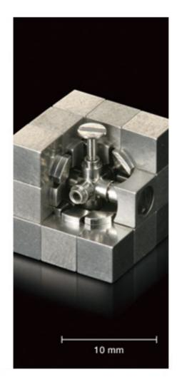
05年的获奖作品,1厘米的魔方。39个的零部件的立方体,高精度加工,实现着顺畅的转弯↓
